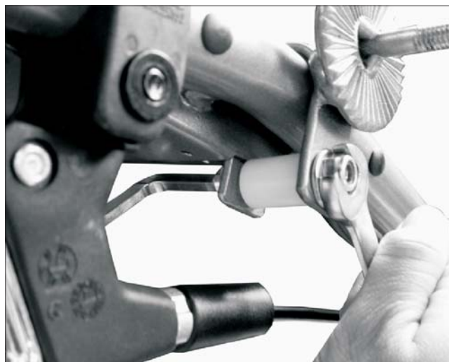
4. Apretar con llave allen y llave fija el tornillo de fijación inferior con su casquillo.
