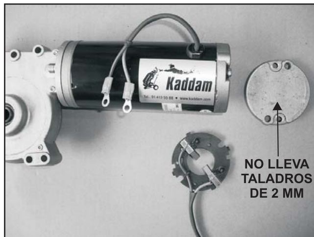
MOTOR LEMAC 25:1 (65179-302 y 65179-341) (CONJ. 45111-114) ESCOBILLAS INTERIORES NO SE PUEDE CAMBIAR ESCOBILLA SUELTA SE CAMBIA CONJ. PORTAESCOBILLA COMPLETO
