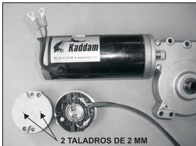
MOTOR LEMAC 36:1 (65179-339) (CONJ. 45111-610) ESCOBILLAS INTERIORES SE PUEDE REEMPLAZAR ESCOBILLA SUELTA (34711-015)
